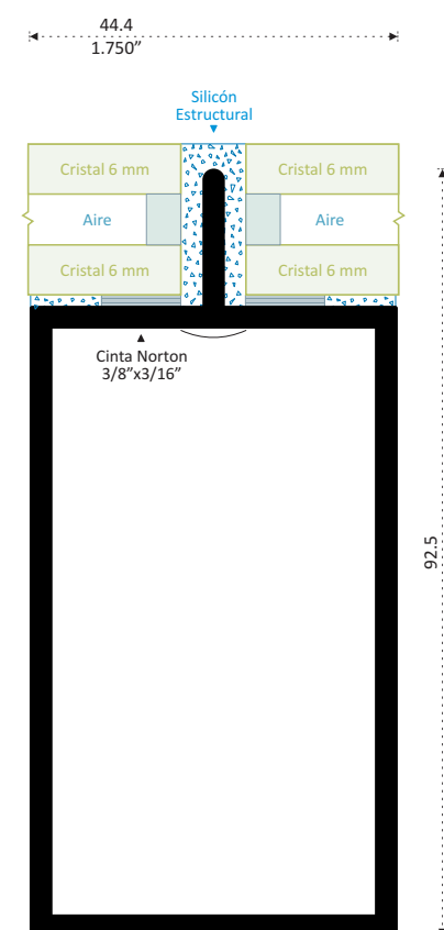
11003 BÁSICO TUBULAR INTEGRAL 3" X 1 3/4" Longitud 6.10 m
