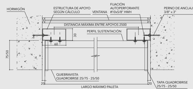
DETALLE QUADROBRISE 25/75 - 25/50 APLICACIÓN CIELO CORTE B-B
